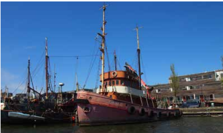
Borneokade, foto voor en na de verlenging en verbouwing van de zeesleepboot Hunter tot woonschip. (Ontwerp: Scheepswerf Talsma)
